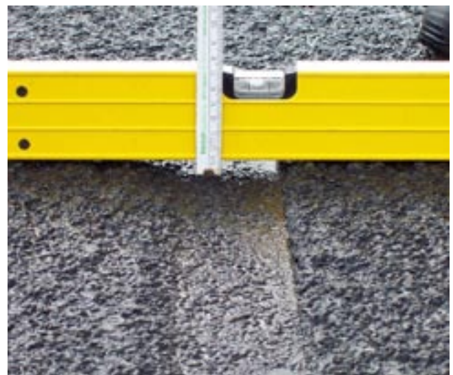
Bild 3: Eindrückungen von mehr als 1 cm sind keine Seltenheit Foto: Schnorpeil
