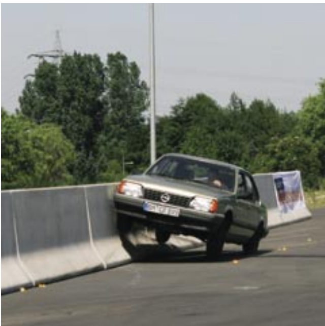
Bild 1: Betonschutzwände, Fahrer und Auto hatten eine harte Bewährungsprobe zu bestehen: den dreifachen Anprall eines Pkws mit 80 km/h und Anfahrwinkeln von 8°, 12° und 15°
